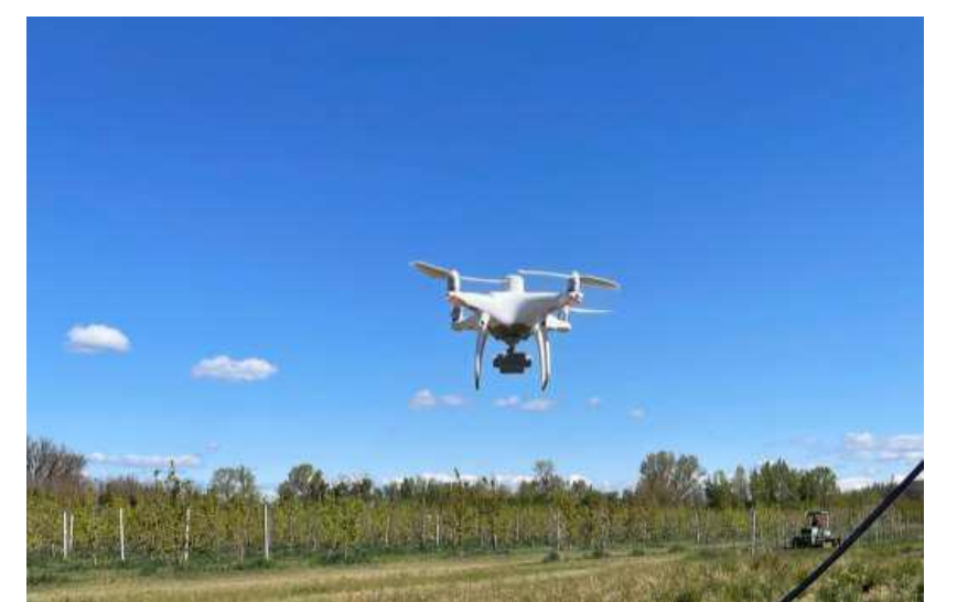
Figura 2 – Drone modello Phantom 4 DJI Multispectral, utilizzato per la prova (elaborazione propria).
